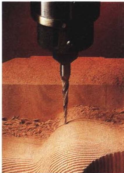
Foto 1 - Una fresatrice a controllo numerico a lavoro. Al contrario delle macchine LMT (stereografia o sinterizzazione), questa macchina lavora per «sottrazione» o per asportazione. Un vantaggio significativo offerto dai metodi LMT, rispetto a queste tecniche tradizionali a controllo numerico, è la semplicità e la conseguente rapidità della fase di post-processing dei dati. Infatti non bisogna programmare i percorsi utensili, e data la natura del processo non sono necessari controlli su possibili collisioni dell'utensile stesso contro parti del modello o contro i sistemi di fissaggio. Nelle tecniche LMT di fatto l'utensile è un fascio laser.
